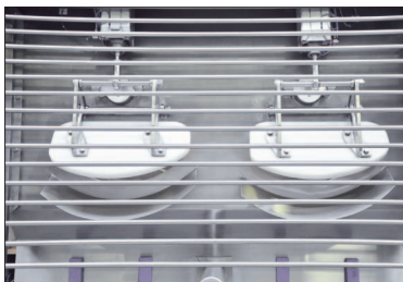
Discharge outlets of PSS SOM
