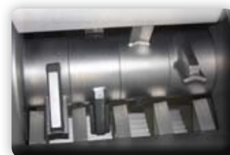
Trichter des "BB-3000" mit 4 Doppelbrechern / funnel of the "BB-3000" with 4 double breakers
